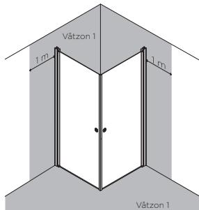
Skruvinfästningar i väztzon 1 ska göras i betong eller annan massiv konstruktion (a), träreglar, träkortlingar (b) eller i konstruktion som är provad och godkänd för infästning, till exempel skivkonstruktion (c). Se exempel på godkända konstruktioner på säkervatten.se. Alla infästningar i väztzon 1 och 2 ska tätas. Material för tätninng ska fästa mot underlaget och vara vattenbeständig, mögelresistant och åldersbeständigt.
